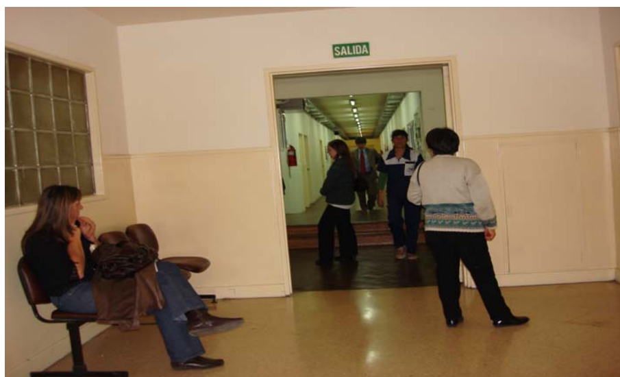
Foto N ° 12 Vista del pasillo del 2° piso, es de notar que la señalización se reduce a pocos carteles y no encontramos en los pisos alguno que indique la “salida de emergencia”.
